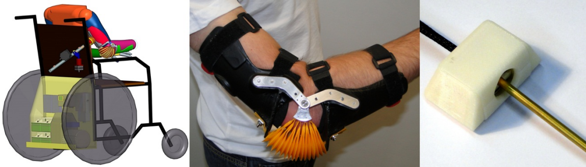
Abb. 45: links: CAD Modell des Gesamtsystems mit Ellbogenorthese, Schulterssystem und der Peripherie, Mitte: Prototyp der Ellbogenorthese mit Druck / Zug FFA, Rechts: 2D Schulterjoystick zur Steuerung des Systems
