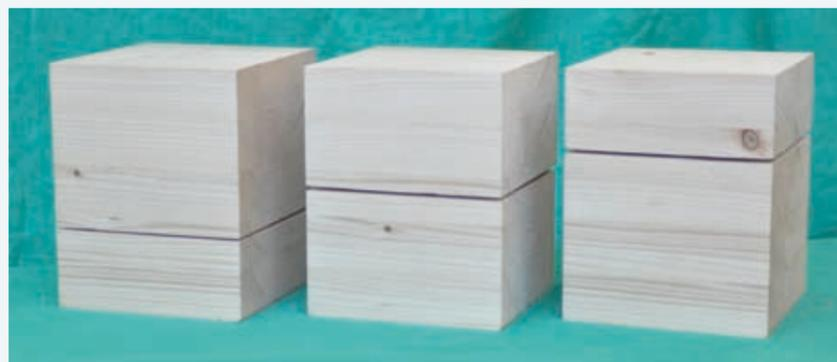
Bild 6: Prüfkörper für Einschraubversuche mit Spannschrauben, Druckmessung jeweils in den Einschraubtiefen 50 mm; 100 mm und 150 mm
