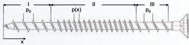
Bild 1: Schematische Darstellung einer Spanschraube mit veränderlicher Gewindesteigung. Bereich I und Bereich III mit konstanter Gewindesteigung  $p_0$ , Bereich II mit veränderlicher Steigung  $p(x)$ .
