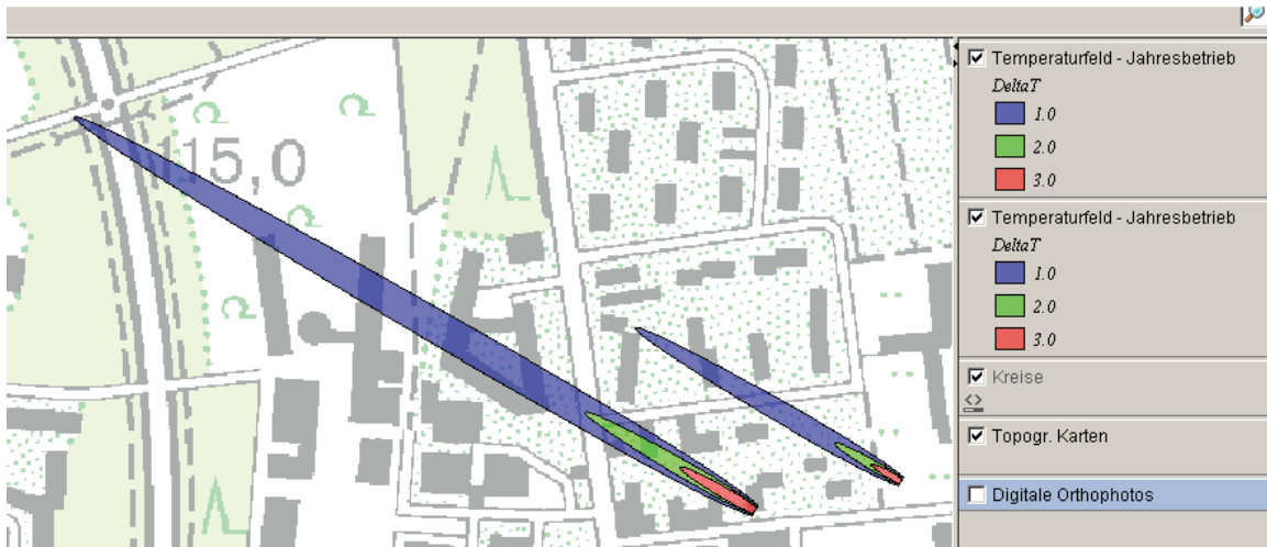
Abbildung 2: Mit der Fachanwendung Grundwasser berechnete Temperaturfelder
