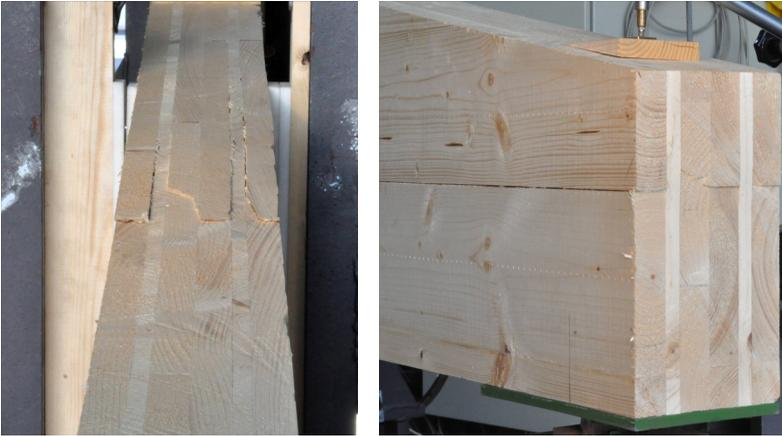
*Bild 4-9 Prüfkörper RO 900/5 – Schubversagen am Rand schräg zur Faserichtung (links) und am unteren Rand der obersten über die gesamte Länge durchlaufenden Brettlamelle (rechts)*
