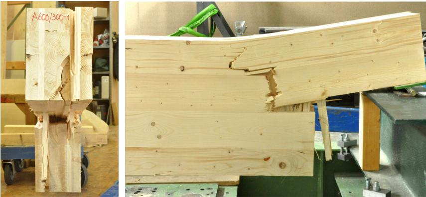
Bild 4-27 Schubversagen in den Kreuzungsflächen neben der Ausklinkung bei Prüfkörpern A 600/200-1 (links und rechts)
