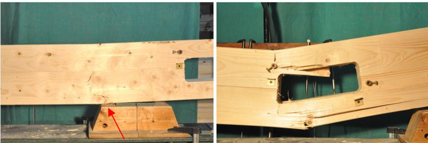
Bild 4-18 Biegebruch im ungeschwächten Querschnitt zwischen den Durchbrüchen bei Prüfkörper DB 300/120-2 (links) und Biegebruch im Nettoquerschnitt bei Prüfkörper DB 300/120-3 (rechts)
