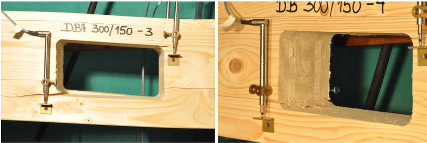
Bild 4-19 Schubversagen in den Kreuzungsflächen bei Prüfkörper DB 300/150-3 (links) und Prüfkörper DB 300/150-4 (rechts)
