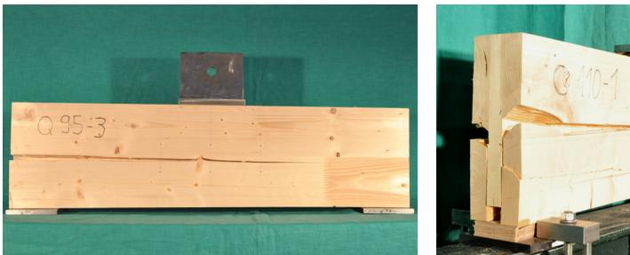
Bild 4-30 Schubversagen in den Kreuzungsflächen an den Auflagern bei den Prüfkörpern Q 300/95-3 (links) und Q 300/110-1 (rechts)
