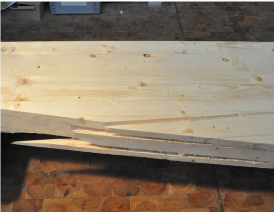
*Bild 4-10 Prüfkörper RU 900/1 – Versagen am Rand schräg zur Faserrichtung*
