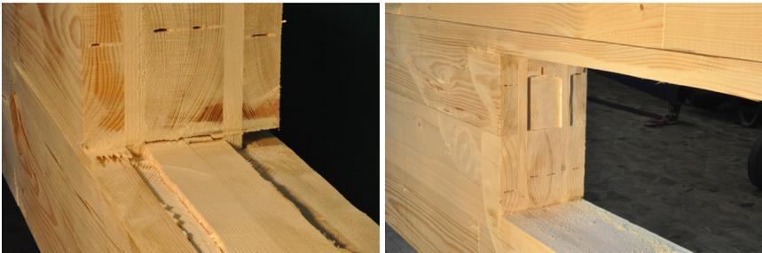
Bild 4-20 Schubversagen in den Kreuzungsflächen bei Prüfkörper DB 600/300-4 (links) und Prüfkörper DB 600/240-3 (rechts)
