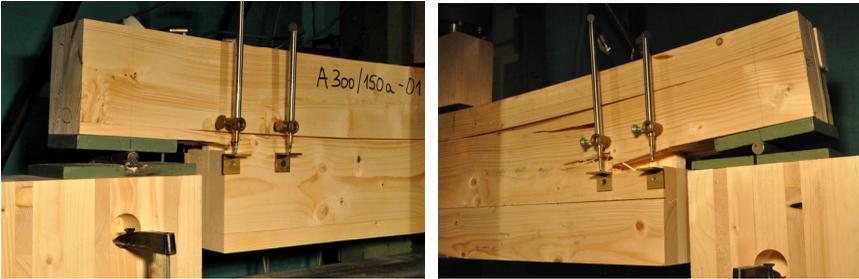
Bild 4-26 Schubversagen in den Kreuzungsflächen neben der Ausklinkung bei den Prüfkörpern A 300/100-1 (links) und A 300/110-4 (rechts)
