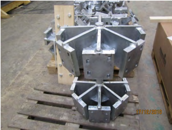
Abb. 7 Sternknoten vor der Verladung. Oben mit Langloch zur Aufnahme von Quellen und Schwinden
