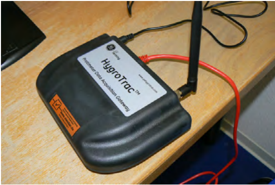
Abb. 8 Datenlogger des Sensornetzwerks
