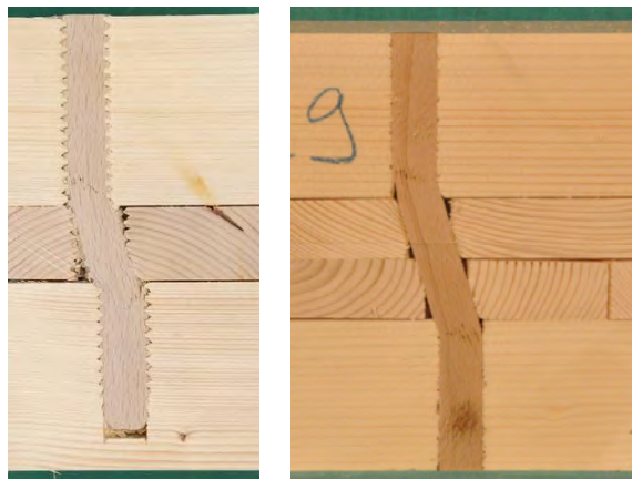
Abb. 11: Stabdübel nach Erreichen der Höchstlast
