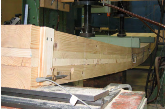
Abb. 9 Biegeversuch zur Ermittlung des Verschiebungsmoduls
