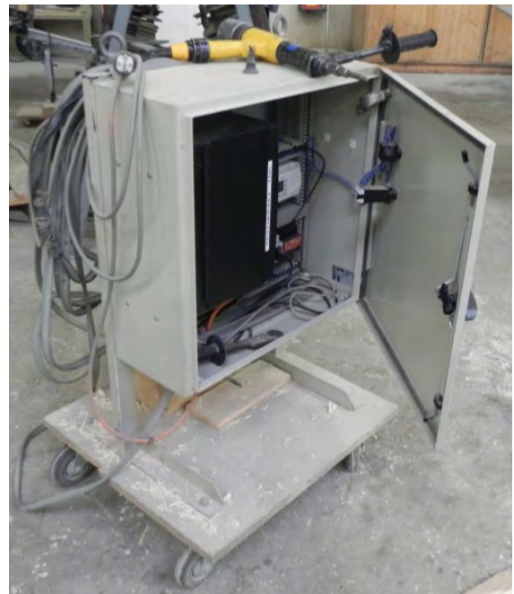
Abb. 11 Schraubgerät zum Eindrehen der Vollgewindeschrauben
