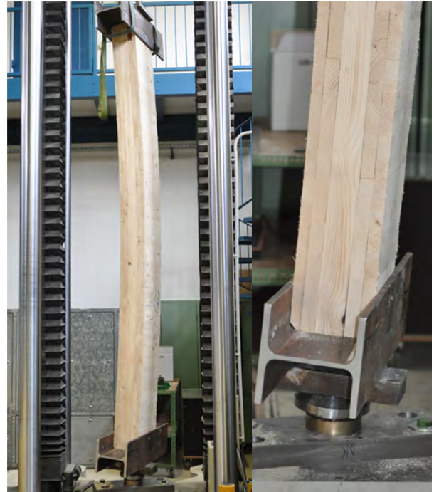
Abb. 12: Ausknicken von Wandelementen
