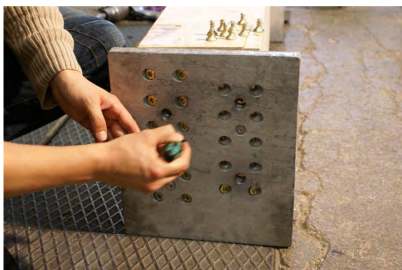
Abb. 14 Bruch der Vollgewindeschrauben
