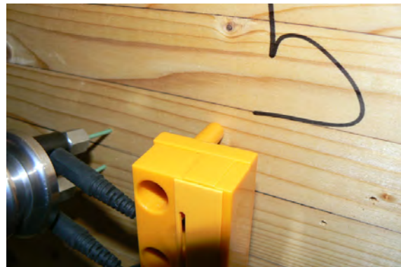
Abb. 10 Handmessung der Holzfeuchte im Vergleich zu den Sensordaten
