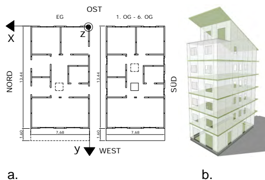
Abb. 3 Siebenstöckiges Gebäudes, a. Grundriss, b. Rendering
