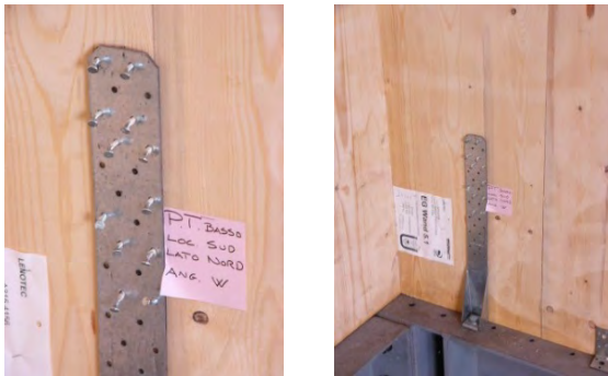
Abb. 8 Dreistöcker, Zugankerversagen nach Nocera Umbra 1,20g
