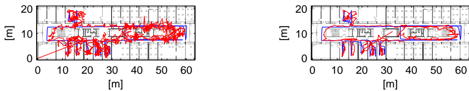
(a) EKF, mittlerer quadratischer Fehler 2,28\text{ m} . (b) Partikelfilter, mittlerer quadratischer Fehler 2,07\text{ m} .
