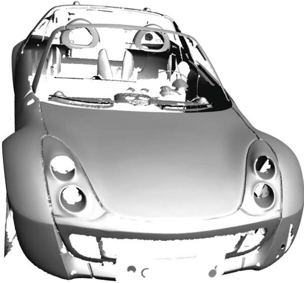
Abbildung 2.8: Scan mit einem Weißlichtstreifenscanner.
