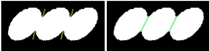
Abbildung 14.6: Für die Objekttrennung relevante Äste des Skeletts (gelb, links), ermittelte Trennlinien (grün, rechts).
