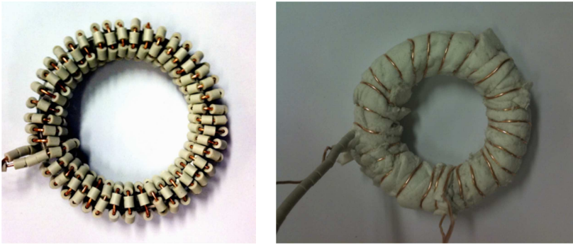
Abb. 3-20: Aufbau der Primärspeule (links) und der Sekundärspeule (rechts)
