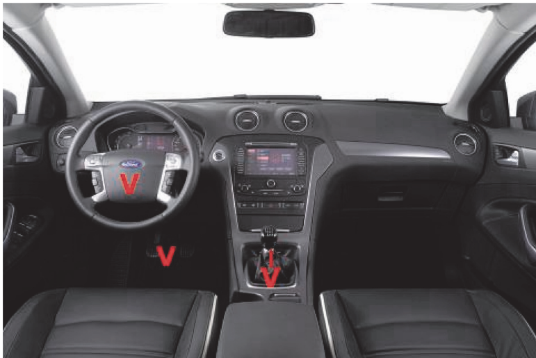
Abbildung 28: Grundsätzliche Definition der Basiskonfiguration und der variablen Elemente nach Form (gekennzeichnet mit „V“) laut Anforderungsliste für die EMO VR-Studie
