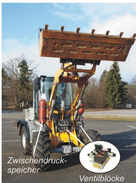
2: Versuchsträger am Mobima: Radlader Paus RL 655
