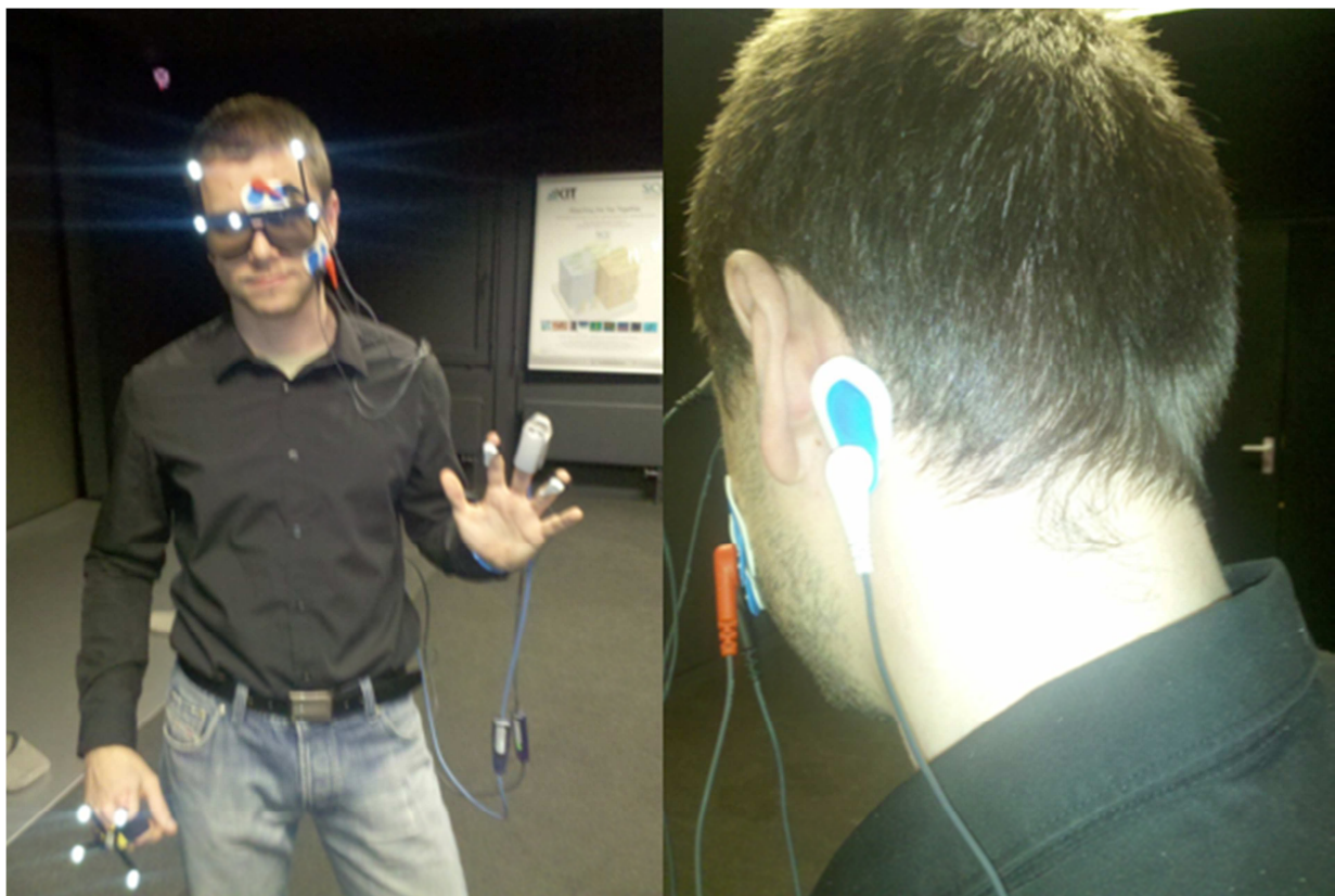
Abbildung 30: Versuchsausrüstung für die EMO VR-Studie: 3D-Brillen mit passiver Stereoprojektion und A.R.T. Tracking sowie Handband mit Sensoren zur Interaktion (links); EMG-Elektroden im Gesichtsbereich (links und rechts), EDA- und BVP-Sensoren an der nicht-aktiven Hand (links) und Erdung (rechts) zur Emotionserfassung
