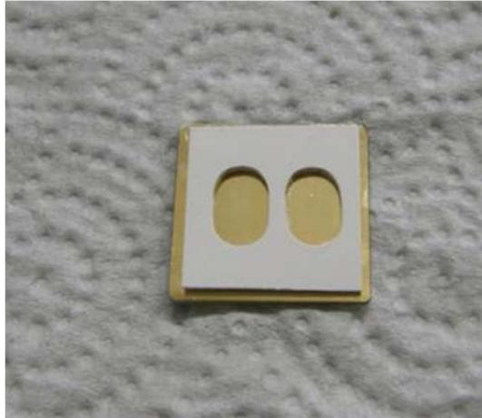
**Abb. 69** Die beiden Messkammern auf dem Goldchip.
