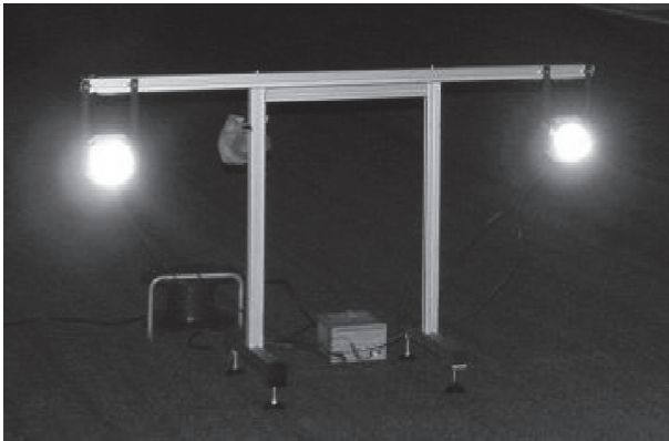
Abbildung 53: Rack mit Halogen-Projektionscheinwerfern zur Simulation des Gegenverkehrs [Ric08]
