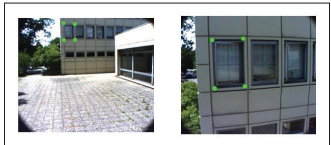
BILD 9: Detektiertes Fenster zu Beginn des Anfluges (links) und bei Erreichen der Endposition (rechts).
