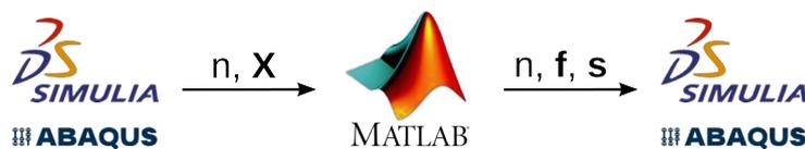
Abbildung 7.2: Ablaufplan zur Erstellung der initialen Faserorientierung
