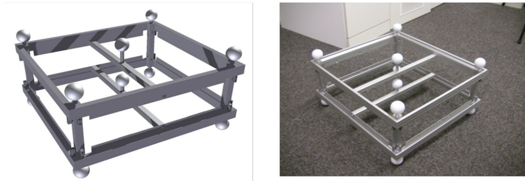
Abbildung 4.5: Modell (links) und Bild (rechts) des 3D-Körpers zur Überprüfung der 3D-Koordinatenbestimmung [Blunck et al. 2011b].
