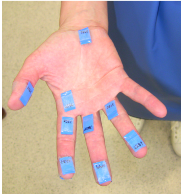
Abbildung 6.8: TLDs in Taschen verpackt und an der Hand befestigt. Die Abbildung zeigt als Beispiel die Befestigung der TLDs vor einer Therapiedurchführung.
