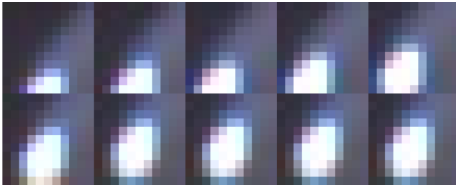
Abbildung 4.6: Annäherung an den Markermittelpunkt (Zentrum des Fensters) ausgehend vom Ausgangspixel (links oben) und nach neun weiteren Iterationen. Bereits nach sechs Iterationen ist keine Änderung mehr vorhanden.
