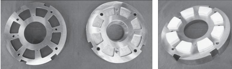
Bild 5-2: Werkzeugisolierung mit keramischen Einsätzen [Ham09a]
