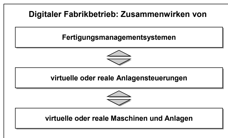
Abbildung 95: Kopplung auf unterschiedlichen Ebenen im Digitalen Fabrikbetrieb [VDI4499 – Blatt 2]
