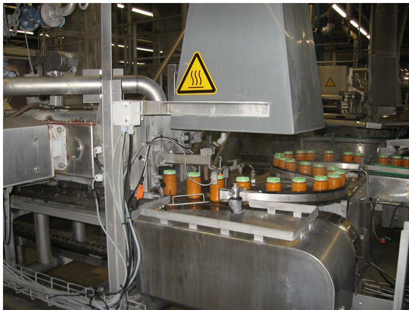
Abbildung 197: Glas-Abfüllanlage für Babynahrung [Bildquelle Nestlé Deutschland AG]
