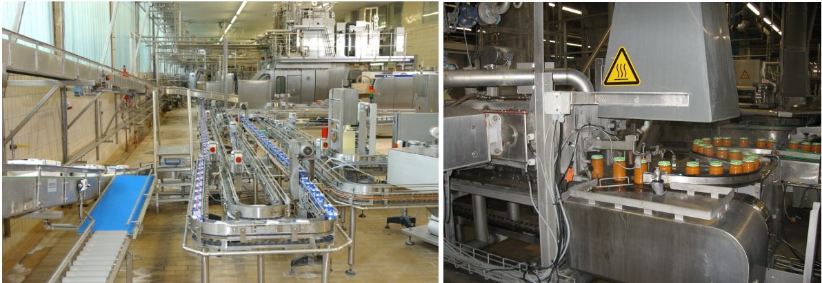
Abbildung 152: Tetra-Abfüllanlage in der Produktionshalle der Flüssigabfüllung [Bildquelle Humana Milchindustrie GmbH], Glas-Abfüllanlage für Babynahrung [Bildquelle Nestlé Deutschland AG]
