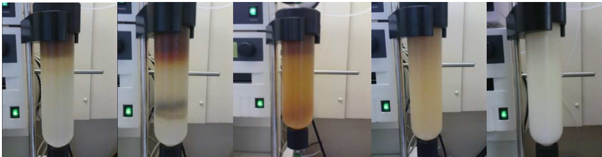
Abb. 3.1: Fotografien der präoperativen Säule während der Durchführung der Chromatographie in Anlehnung an Andrä. Es wurden 5 g Rohextrakt auf die Säule gegeben. Die einzelnen Bilder wurden in zeitlichen Abständen von etwa 30 min aufgenommen.
