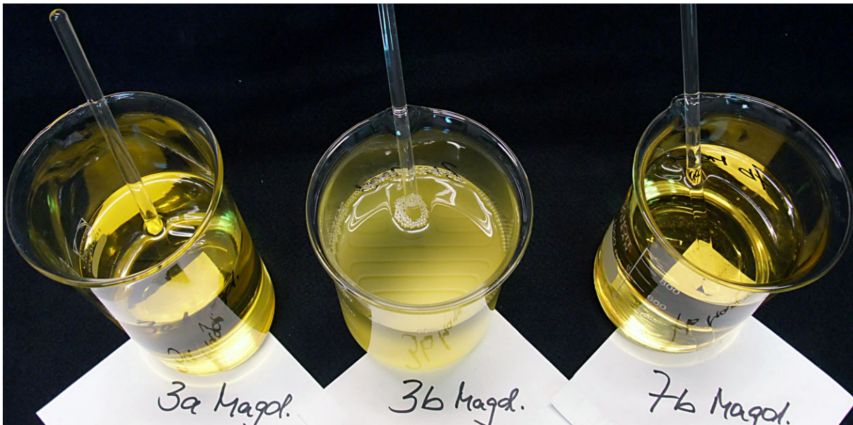
Bild 4.1: Künstlich gealterte Flüssigkeiten (3a M, 3b M, 7b M) nach 12 Wochen bei 55 °C und 6 Wochen bei 23 °C unter Einwirkung von Tageslicht, erkennbar ist die ausgeprägte Trübung bei 3b M, die ebenso bei 3b L auftrat (hier nicht dargestellt)
