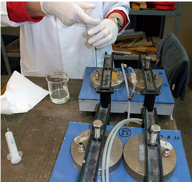
Bild 4.15: Befüllen der Druckzylinder mit den Flüssigkeiten für die Versuche unter Überdruck (1,0 bar)
