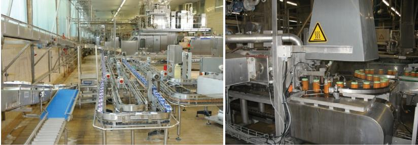
Abbildung 152: Tetra-Abfüllanlage in der Produktionshalle der Flüssigabfüllung [Bildquelle Humana Milchindustrie GmbH], Glas-Abfüllanlage für Babyernährung [Bildquelle Nestlé Deutschland AG]
