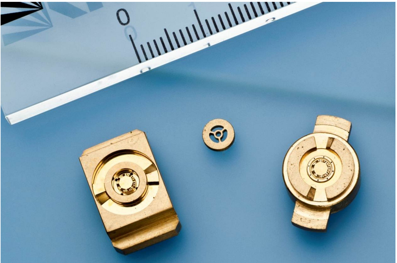
Abbildung 2.10 Der Formeinsatz für das Leitrad mit komplexen Trennebenen und Dreh-Schließmechanismus (Bildmitte: Urmodell Lagerschild). Foto mit freundlicher Genehmigung von Herrn Markus Breig (2012).
