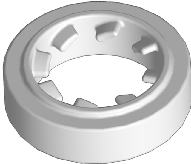
Abbildung 6.3 CAD-Modell des Leitrads. Auf der Stirnseite ist die abgesetzte Fläche zur Positionierung der Angüsse erkennbar.
