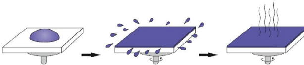
Bild 3.11.: Darstellung des Spincoating-Prozesses. Die Lösung wird auf das Substrat pipettiert. Durch die Rotation des Chucks wird der Nassfilm gleichmäßig auf dem Substrat verteilt und durch die Trocknung bildet sich ein homogener Film. [145].
