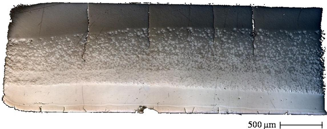
**Abb. 5.26: Gradierte gesinterte Probe der 1. Charge:
