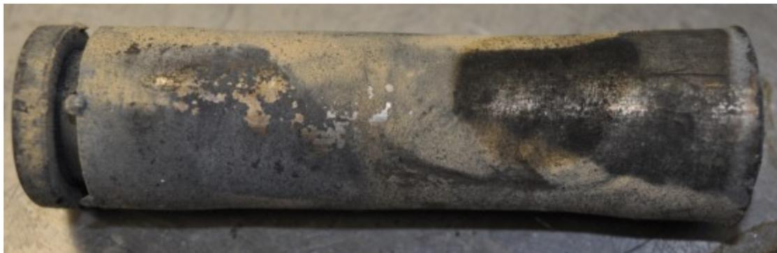
**Abb. L.2: Pulveraufnahme-Container mit herausragendem unteren Stopfen nach einer Sprengung.**
