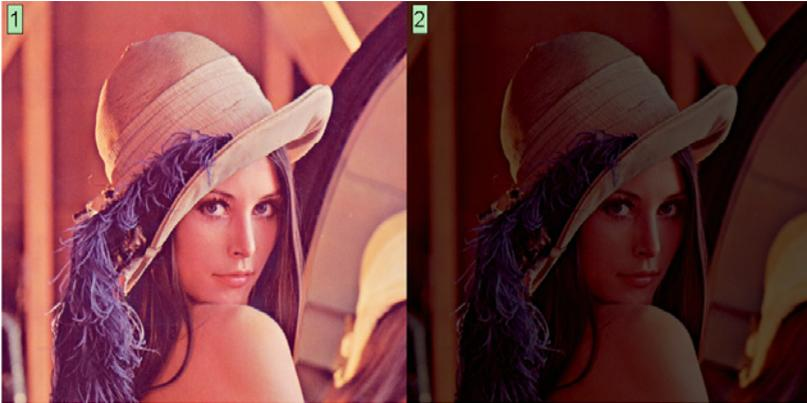
**Abbildung 3.8.:** Visualisierung der Graustufenwahrnehmung bei einem simuliertem Umgebungslichteinfluss von  $L_e = 0.1 \cdot L_{w,s}$  für eine Betrachtung an einem Monitor mit  $C_{r,d} = 150 : 1$ ; 1 Originalbild; 2 Simulation der Wahrnehmung bei Umgebungslicht, Bildquelle: [29]
