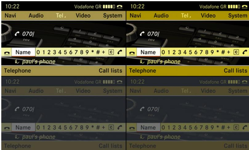
**Abbildung 5.20.:** Oben-links: Originalbild, Oben-rechts: Beispiel für eine Anhebung der Sättigung um 30%, Unten: Beispiel bei simuliertem Umgebungslicht mit  $L_w = 400\text{cd}/\text{m}^2$  bei Umgebungslichteinfluss  $L_e = 0.1 \cdot L_w$  und einer Adaptionsleuchtdichte von  $L_a = 2500\text{cd}/\text{m}^2$ , links: ohne und rechts: mit Anhebung der Sättigung
