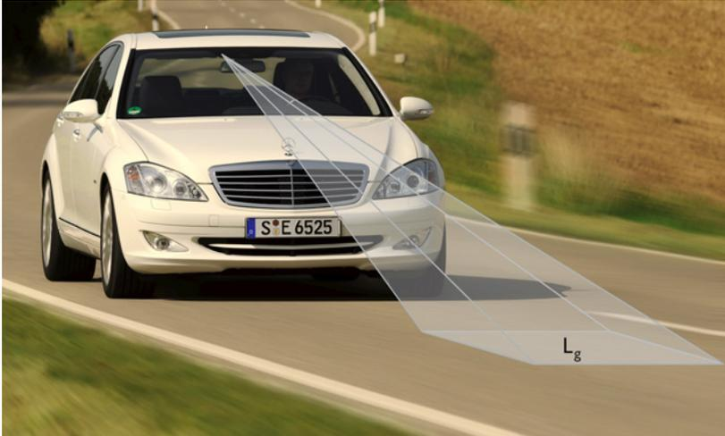
**Abbildung 4.2.:** Messbereich des Blendlichtsensors
