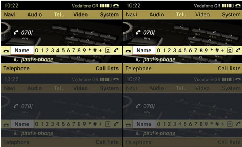
**Abbildung 5.18.:** Oben-links: Originalbild ohne Umgebungslichteinfluss, Oben-rechts: Beispiel für eine Anhebung der Akutanz unter Anwendung eines  $3 \times 3$  Laplace Filter  $H_*^L$  mit  $w=0.15$  ohne Umgebungslichteinfluss, Unten: Beispiel bei simuliertem Umgebungslicht mit  $L_w = 400cd/m^2$  bei Umgebungslichteinfluss  $L_e = 0.1 \cdot L_w$  und einer Adaptionsleuchtdichte von  $L_a = 2500cd/m^2$ , links: ohne und rechts: mit Anhebung der Akutanz
