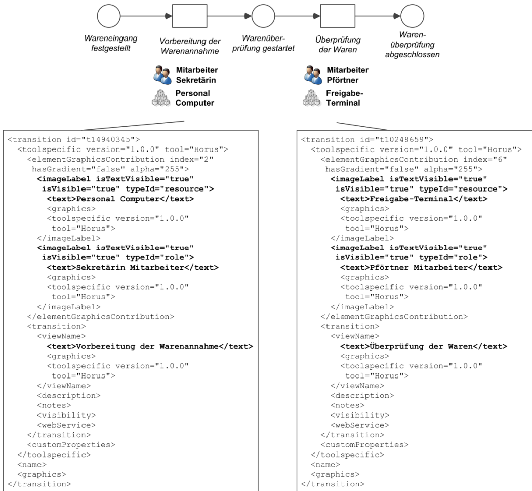
Abbildung 45: Maschinelle Ressourcen und Auszüge der korrespondierenden PNML-Datei
