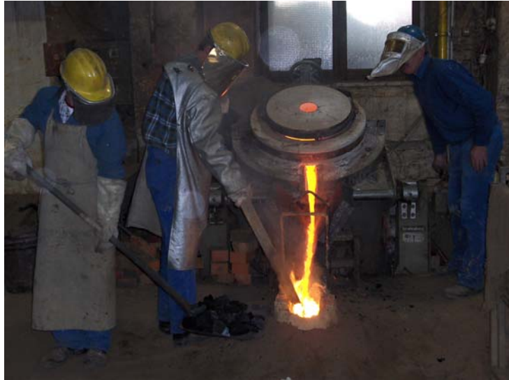
Abbildung 1: Glockenguss, Glockengießerei Perner, Passau, 30. Mai 2007
