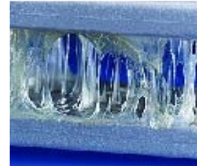
Abb. 1: Fibrillation in aufreissender Klebschicht (Fraunhofer IFAM)
