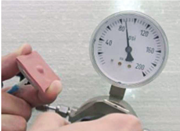
Abbildung 48: Aufnahme zur experimentellen Überprüfung der Bondstärke zwischen PDMS und Accura® 60. Der Versuchsaufbau ist angelehnt an die Versuche von Eddings et al. [78]. Der Bond hält einem Druck von über 80 psi (550 kPa bzw. 5,5 bar) stand.
