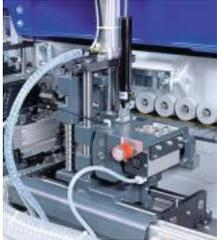
*Stellknöpfe integrieren Verstellelement und Anzeige in einem Gerät*
