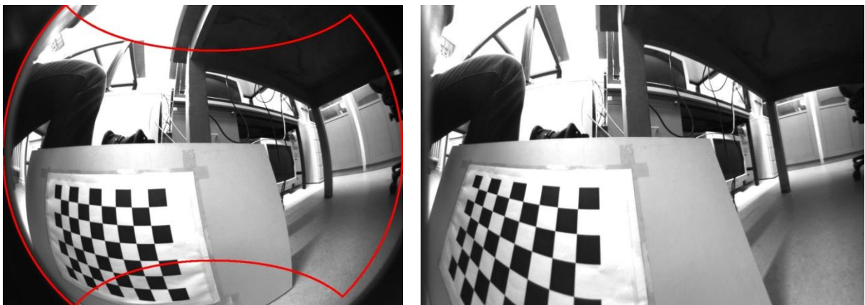
Abbildung 3: Aufnahme einer Bildes mit Fisheye-Optik (links) und entzerrtes/kalibriertes Bild
