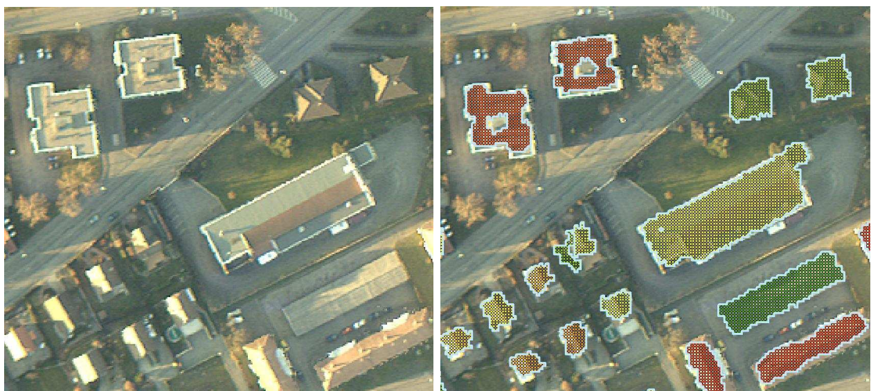
Abbildung 5: Georeferenziertes RGB-Orthobild Abbildung 6: Farbcodierte Gebäudesegmente (Höhe von grün nach rot zunehmend)
