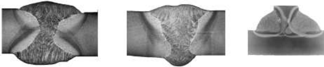
Abbildung 33: Makroschliffbilder 26 des Werkstoffs S690 QL1 mit artgleichem Zusatzwerkstoff und von links nach rechts mit X, V und DHV-Nahtvorbereitung, Plattendicke 10 mm
