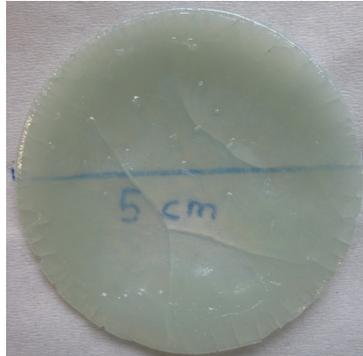
**Abbildung 3.1:** Elektrophoretisch abgeschiedene Probe
