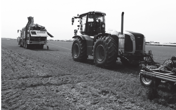
Abb. 2: Test- und Bremsfahrzeug im Zugkraftversuch
