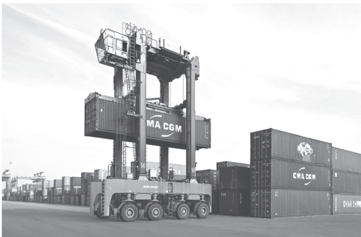
Abb. 1: Straddle Carrier im Betrieb
