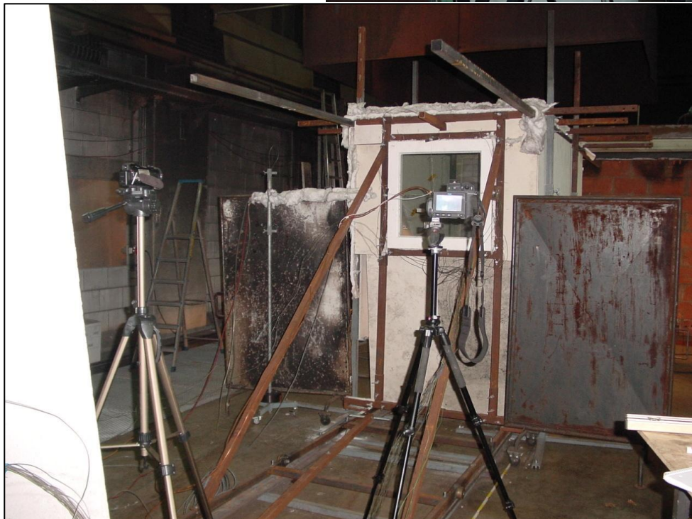
Abbildung 6-9: Versuchsstand mit Wärmebildkamera (Bild oben links: Fotoaufnahme der Firma FLIR, http://www.flir.com /47/ )
