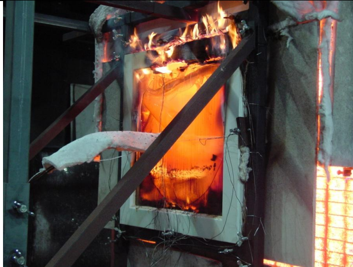
Abbildung 7-23: Versuch FV2-13 - Holz-Rahmen, 3 fach Verglasung (Passivhaus) – Versuchszeit: ca. 30 min
