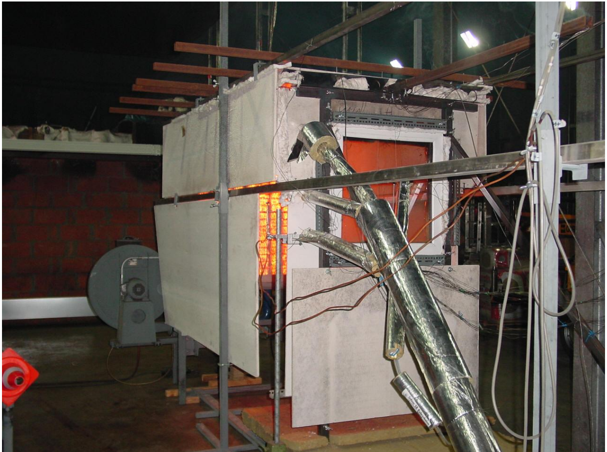
Abbildung 6-3: Versuchstand mit eingebautem Fenster
