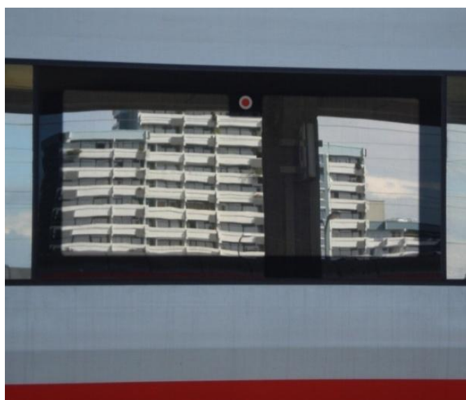
Abbildung 8-23: Außenansicht - ICE Fenster mit Sollbruchstelle
