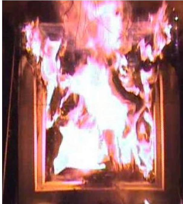
Abbildung 7-21: FV2-9 PVC,3f (Passivhaus): Platzen aller drei Scheiben der Dreischeiben-Wärmeschutzverglasung zeitgleich
