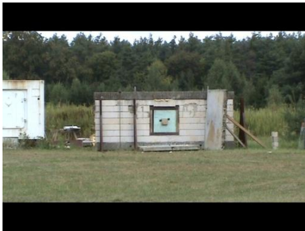
Abbildung 8-15: Versuch 4: Sprengung von VSG mit Sprengschnur, verdämmt
