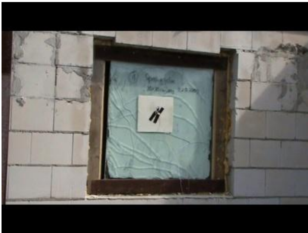
Abbildung 8-12: Versuch 1: Sprengung von VSG mit Sprengfolie
