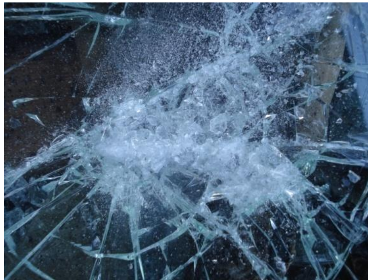
Abbildung 8-5: Bruchbild - VSG Scheibe nach mehrmaligen Hammerschlägen
