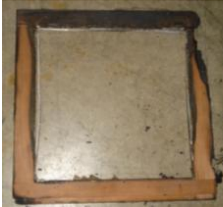
Abbildung 7-26: FV2-10 Holz,2f – Fensterrahmen bei Versuchsende (Temperaturniveau 2)
