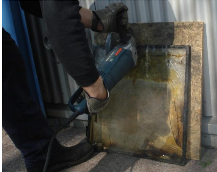
Abbildung 8-6: Einsatz des Trennschleifers an VSG – Scheibe
