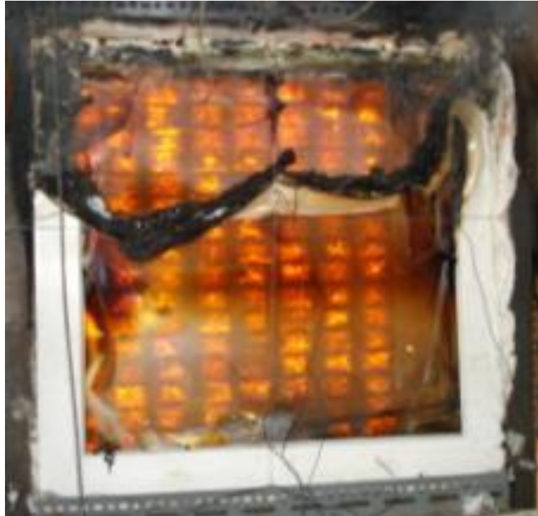
Abbildung 7-28: FV2- 8 PVC 2f – Fensterrahmen bei Versuchsende (Temperaturniveau 2)
