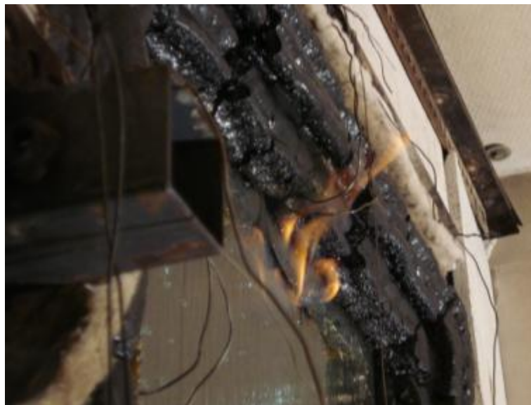
Abbildung 7-33: Flammenbildung aus Rissen (Versuch FV2-11 (PVC-Rahmen, 2 fach Verglasung, äußere Scheibe VSG).
