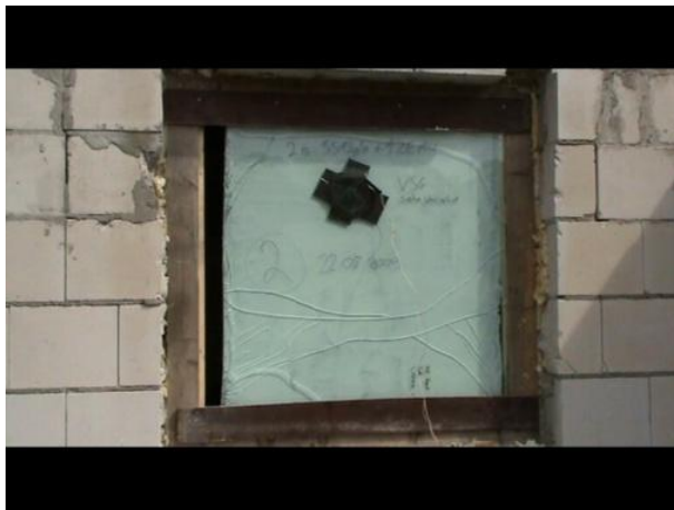
Abbildung 8-13: Versuch 2: Sprengung von VSG mit Sprengschnur, verdämmt
