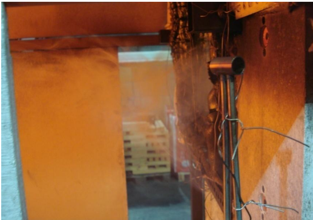
Abbildung 6-7: Bi-direktionale Strömungsmesssonde mit Thermoelement im Spalt Einhausung und Fenster
