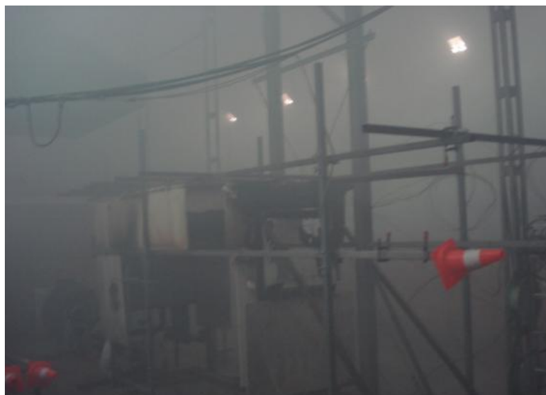
Abbildung 7-30: Starke Verrauchung der Versuchshalle bei Versuchsende bei Versuch FV2-11 (PVC-Rahmen, 2 fach Verglasung, äußere Scheibe VSG)
