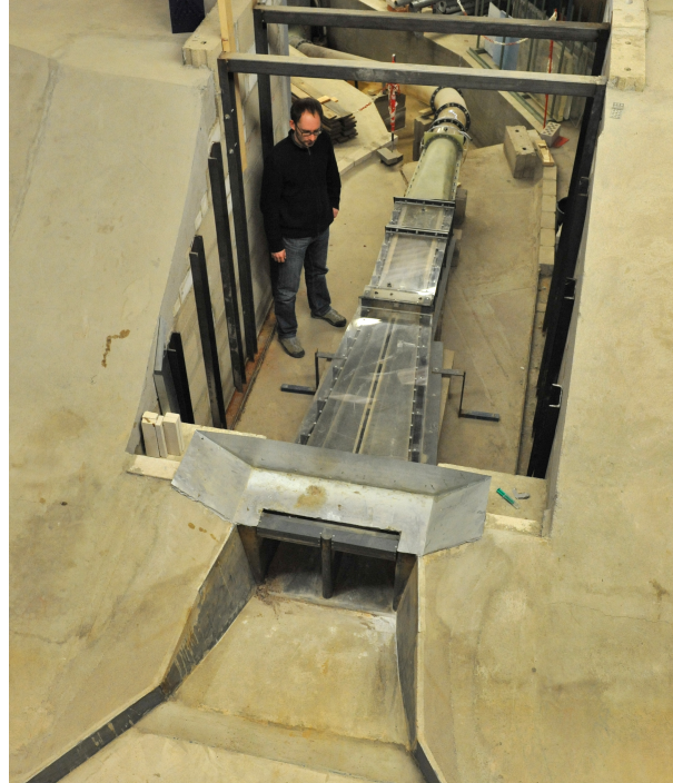
Abbildung 10.9.: Entwurf 1 des Ein- und Auslaufbauwerks im physikalischen Modell.
