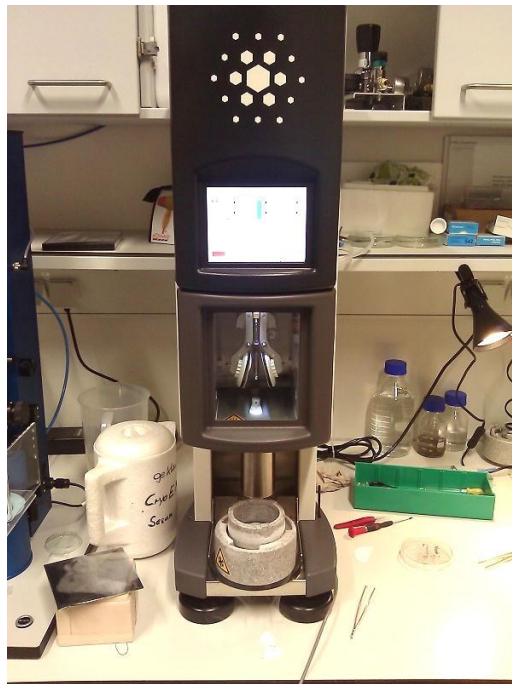
ABBILDUNG 95: VITROBOT VON FEI COMPANY ZUM ERSTELLEN VON VITRIFIZIERTEN PROBEN. DER GRAUE BECHER ENTHÄLT FLÜSSIGES ETHAN, IN WELCHES DIE PROBE GESCHOSSEN WIRD.
