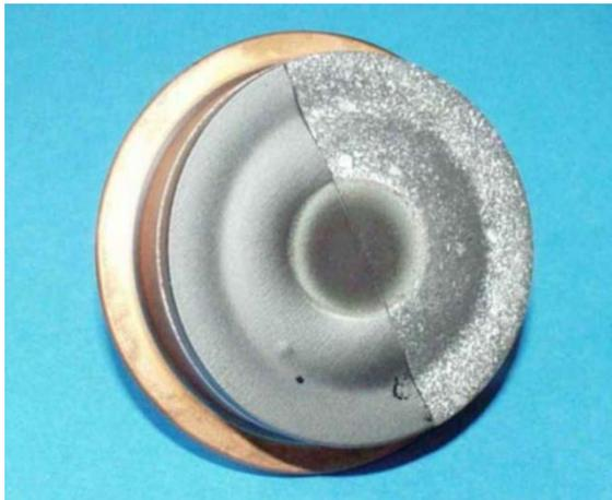
**Abb. 3.10: Schematischer Aufbau der Magnetronsputter-Apparatur [113] bzw. Photographie eines segmentierten Targets [114].**
