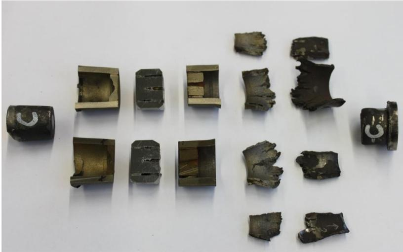
**Abb. 5.30: Von links nach rechts: Oberer Stopfen, Stahlmantelung mit verdichtetem EUROFER97, Bruchstücke der Stahlmantelung, unterer Stopfen.**
