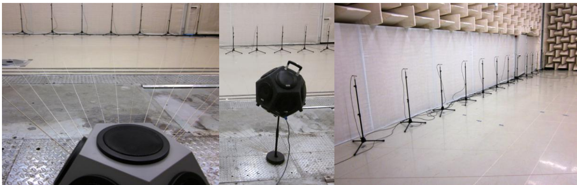
Bild 54: Messaufbau mit Halbdodekaeder(links), Volldodekaeder (mitte) und Mikrofonarray mit 7,5 m Abstand (rechts)
