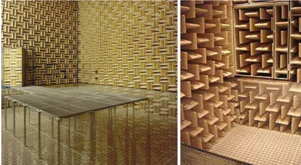
Bild 11: Freifeldraum des Fraunhofer Institutes für Bauphysik IBP (links) 104 und der Ingenieurgesellschaft für Schalltechnik mbH (rechts) 105
