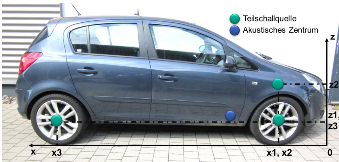
Bild 95: Kleinwagen mit den dominierenden Schallquellen
