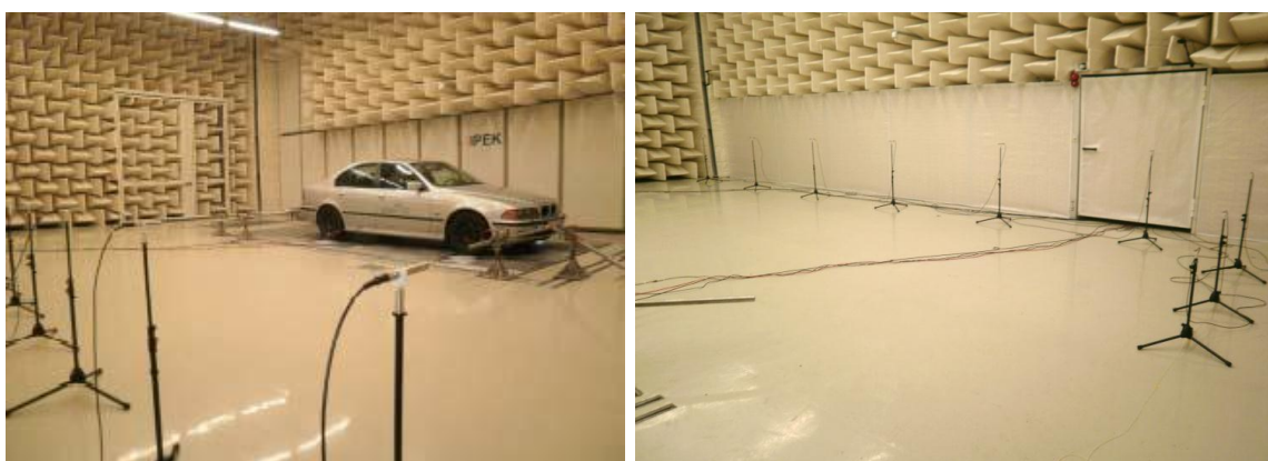
Bild 34: Akustikrollenprüfstand des IPEK: CAR System (links); Keile und Würfel (rechts)
