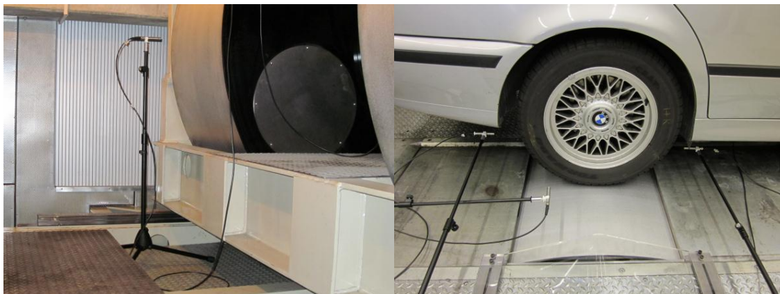
Bild 37: Messung der Trommelgeräusche (links) und Messung der Reifengeräusche (rechts)
