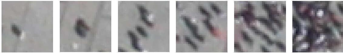
Abbildung 3.3.: Einfluss der lokalen Objektdichte und des Personenschattens auf die Erkennbarkeit von Einzelpersonen.
