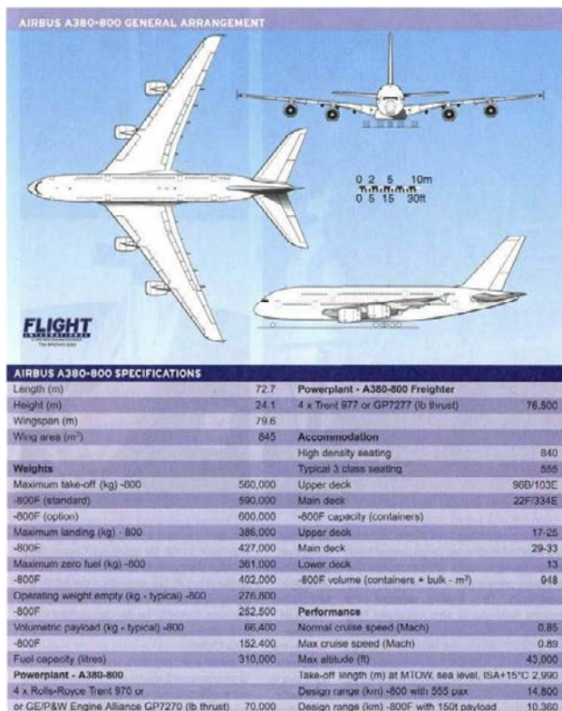
Abbildung 19: 3-Seiten-Ansicht und Leistungsdaten des Airbus A380. Aus Flight Supplement (20.05.2003).
