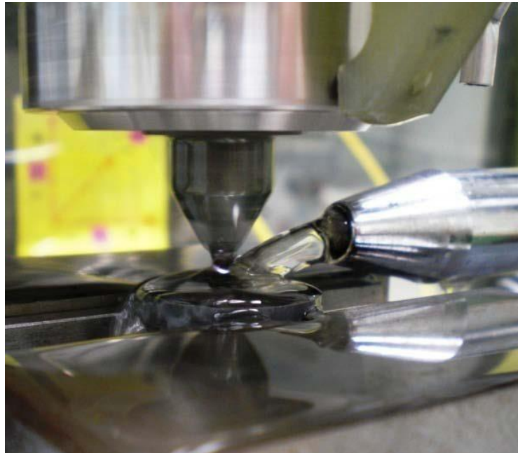
Abbildung 3.2: Spülung des Funkenpalts durch Überspülung des Werkstücks
