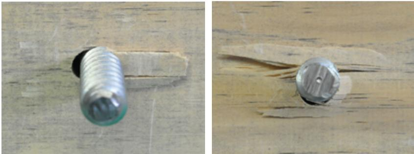
Bild 8-6 (Forts.) Gewindestangen,  $d = 16 \text{ mm}$ ,  $\alpha = 0^\circ$  (l.) und  $\alpha = 90^\circ$  (r.)
