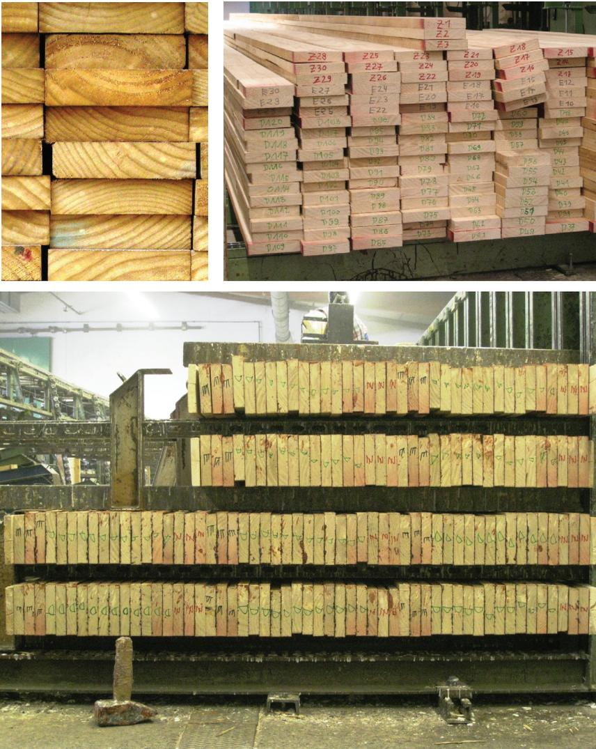
**Bild 7-2** ARK (l. o.), Herstellung der ABSH-Träger beim Projektpartner: Lamellen aus aRK unmittelbar nach dem Keilzinken (r. o.) und Verpressen der Lamellen zu BS-Holz (u.)
