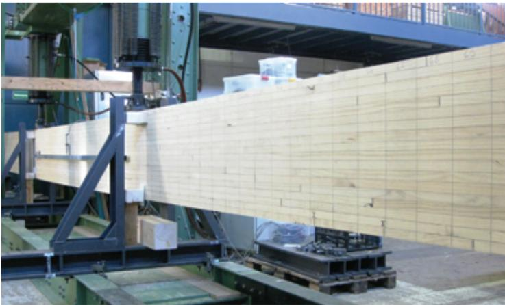
*Bild 2-3 4-Punkt-Biegeversuch an einem ABSH-Träger*
