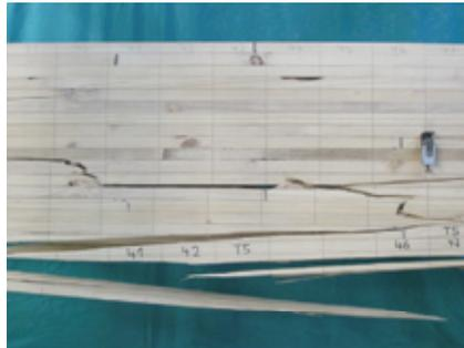
Bild 7-18 c Lokales Versagen E1/4 in der Zugzone (l.) und Bruchbild E1/5 (r.)
