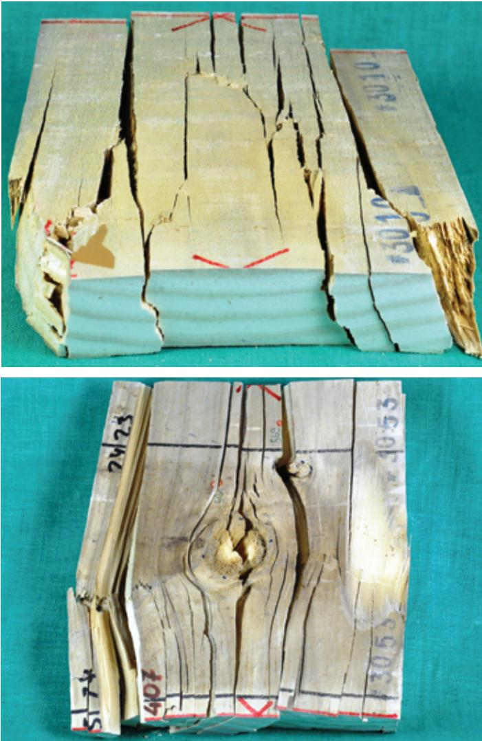
Bild 7-15 (Forts.) Druckversuche an 150-mm-Brettabschnitten: typisches Bruchbild eines astfreien (o.) und astbehafteten Abschnitts (u.)
