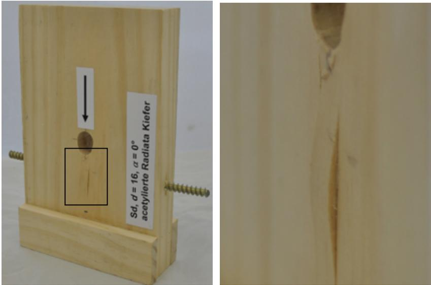
Bild 8-1 Verstärkter Prüfkörper (l.) und lokales Ausknicken der Fasern (r.)
