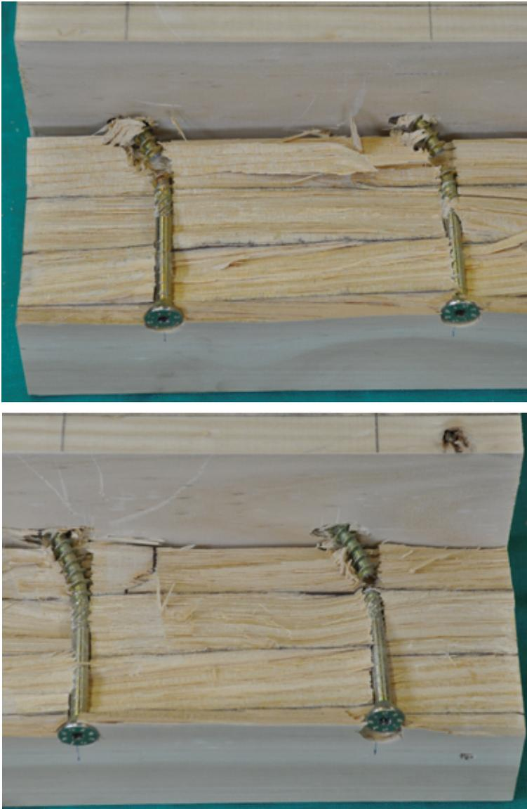
*Bild 8-10      Geöffneter Prüfkörper der Reihe R1: zwei linke (o.) und zwei rechte Schrauben (u.) aus derselben Verbindung*
