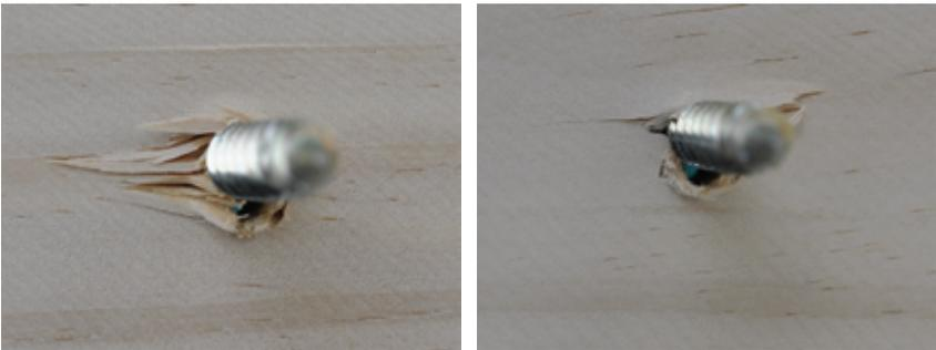
Bild 8-6 (Forts.) Schrauben,  $d = 8 \text{ mm}$ ,  $\alpha = 90^\circ$ , Formen des Lochleibungsversagens
