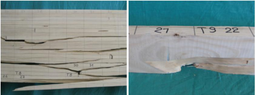
Bild 7-18 e Bruchbild E1/8 (l.) und lokales Versagen E1/9 in der Zugzone, ausgesägter Trägerteil (r.)
