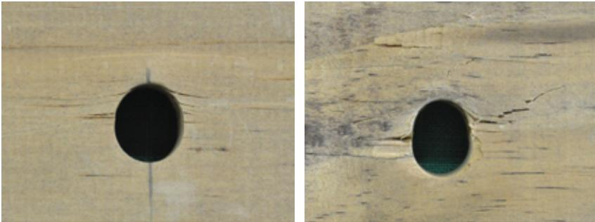
Bild 8-6 (Forts.) Stabdübel,  $d = 16 \text{ mm}$ ,  $\alpha = 90^\circ$ , Formen des Lochleibungsversagens
