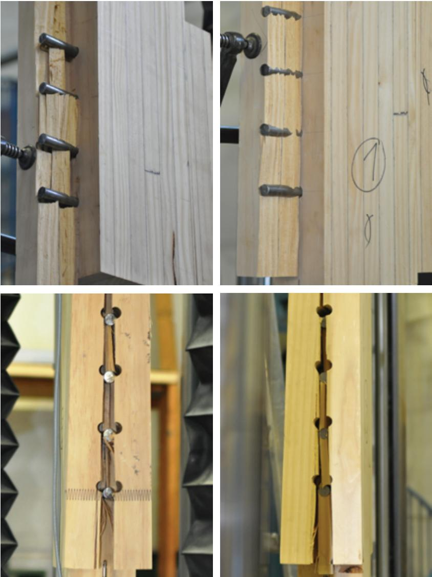
*Bild 8-11 Prüfkörper der Reihe R2: von oben (o. l.) bis unten (o. r.) vollständig gespaltene Seitenlasche und teilweise gespaltene Seitenlaschen (u. l. und u. r.)*
