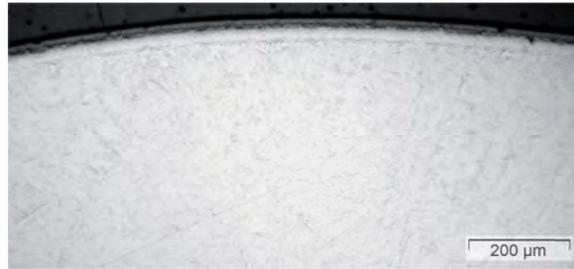
250 mm:  $\delta_{ZrO_2}=4.5 \mu\text{m}$ ;  $\alpha\text{-Zr(O)}=2.5 \mu\text{m}$ ;  $T_{\text{max}}=945 \text{ K}$  (TFS 12/7)
