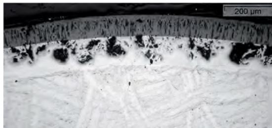
950 mm:  $\delta_{ZrO_2}=90 \mu\text{m}$ ;  $\alpha\text{-Zr(O)}=124 \mu\text{m}$
