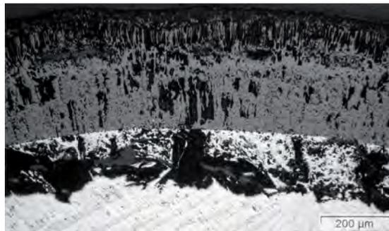
850 mm:  $\delta_{ZrO_2}=363 \mu\text{m}$ ;  $\alpha\text{-Zr(O)}=197 \mu\text{m}$
