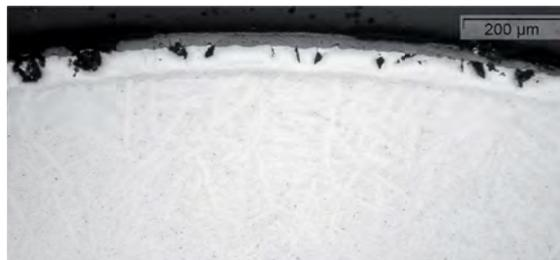
1050 mm:  $\delta_{ZrO_2}=30 \mu\text{m}$ ;  $\alpha\text{-Zr(O)}=53 \mu\text{m}$
