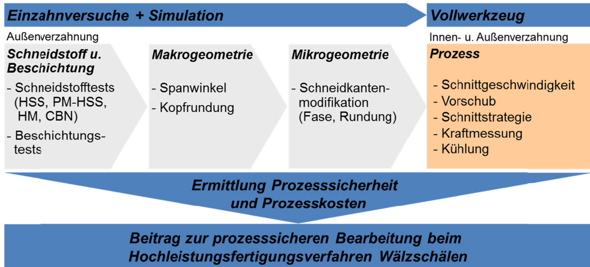
Abbildung 2.5: Methodische Vorgehensweise zur Verbesserung der Prozesssicherheit beim Wälzschälen [BEC-06]
