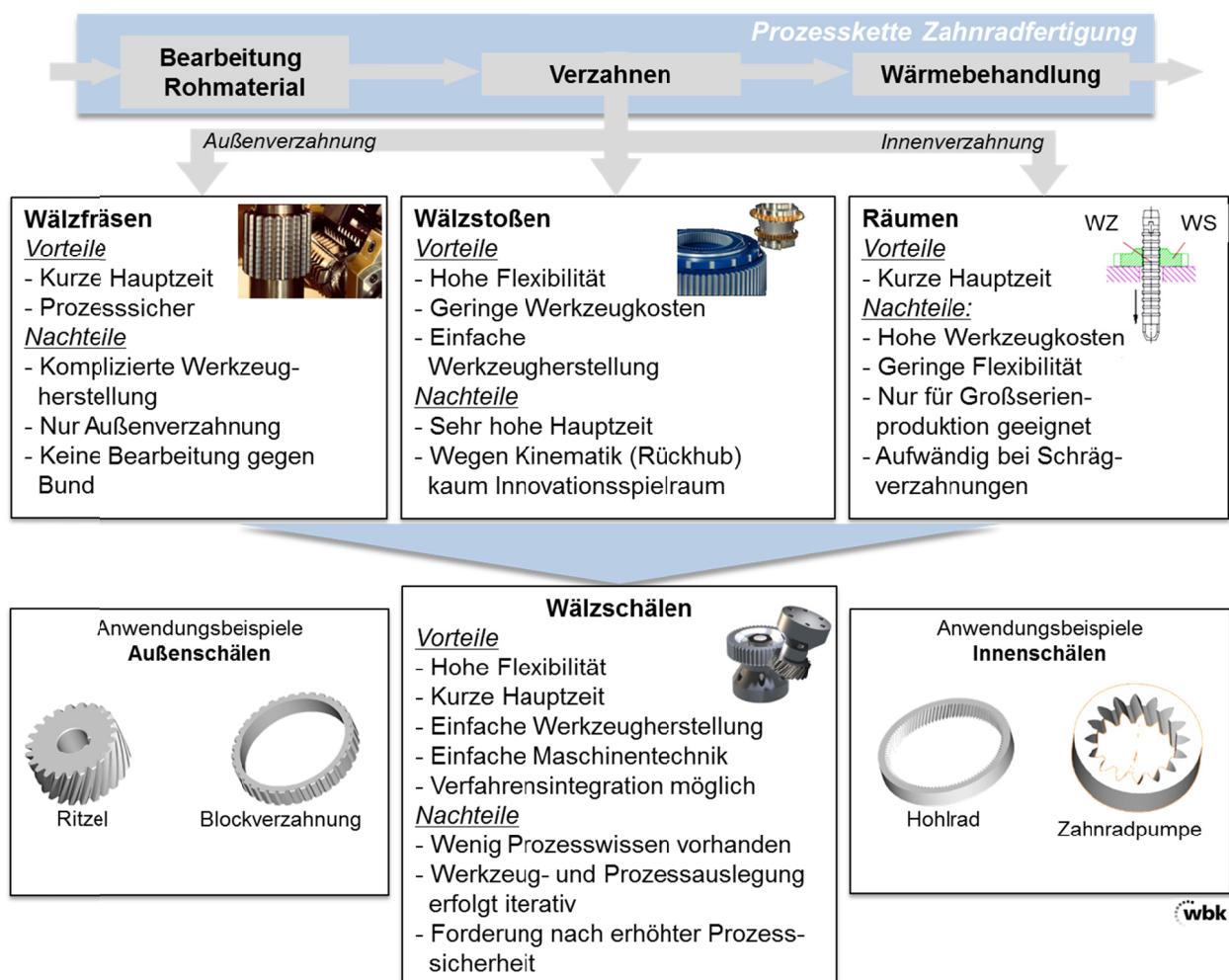
Abbildung 1.1: Verfahrensvergleich Wälzschälen mit etablierten Verfahren der Weichbearbeitung
