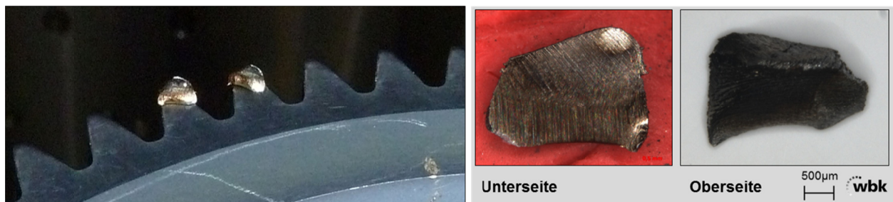
Abbildung 5.21: Aufbauschneiden (am Werkzeug, Unter- bzw. Oberseite)
