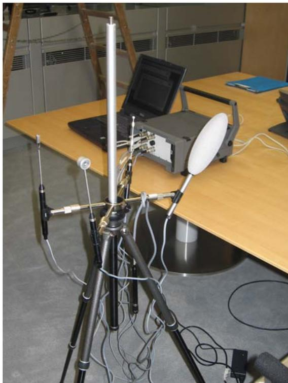
Abbildung 30: Der Raumklimaanalysator für temporäre Messungen des Nutzerkomforts
