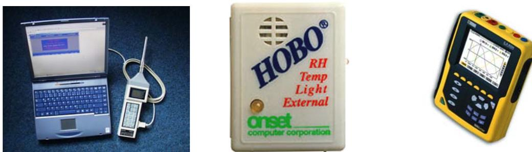
Abbildung 31: Das Schallmessgerät KS-610 (links) wird über die serielle Schnittstelle mit einem Laptop verbunden und ausgelesen. Der „HoBo“-Datenlogger (mitte) mit 4 Messkriterien und seinen kleinen Abmessungen ist äußerst vielseitig einsetzbar. Das Netzanalysegerät C.A.8332 der Firma Chauvin Arnoux (rechts)
