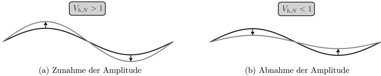
Abbildung 4.3: Änderung der Amplitude in Abhängigkeit von der Vergrößerungsfunktion für \Delta\varphi_N = 0 (schwarz: vor Belastung, grau: nach Belastung)
