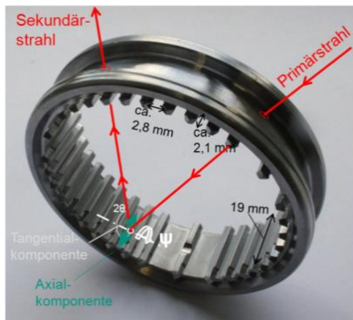
Abbildung 4.2: Ringförmige innenverzahnte Schiebemuffe mit schematischer Darstellung des Strahlengangs im Röntgendiffraktometer sowie der Kippachse \Psi bei Messung der Axialkomponente der Eigenspannungen im Zahngrund; \Psi -Kippung = 0^\circ ; Axial- und Tangentialkomponente werden wie abgebildet definiert.
