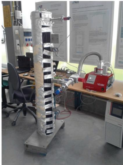
Abb. 4: Bild des Versuchsaufbaus mit Heizmantel und Vakuumpumpe
