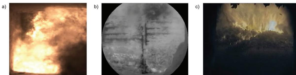
Abb. 3: Aufnahmen an einer Müllverbrennungsanlage a) VIS-Kamera im 1.Zug b) MIR-Kamera im 1.Zug c) VIS-Kamera zur Ausbrandanalyse.
