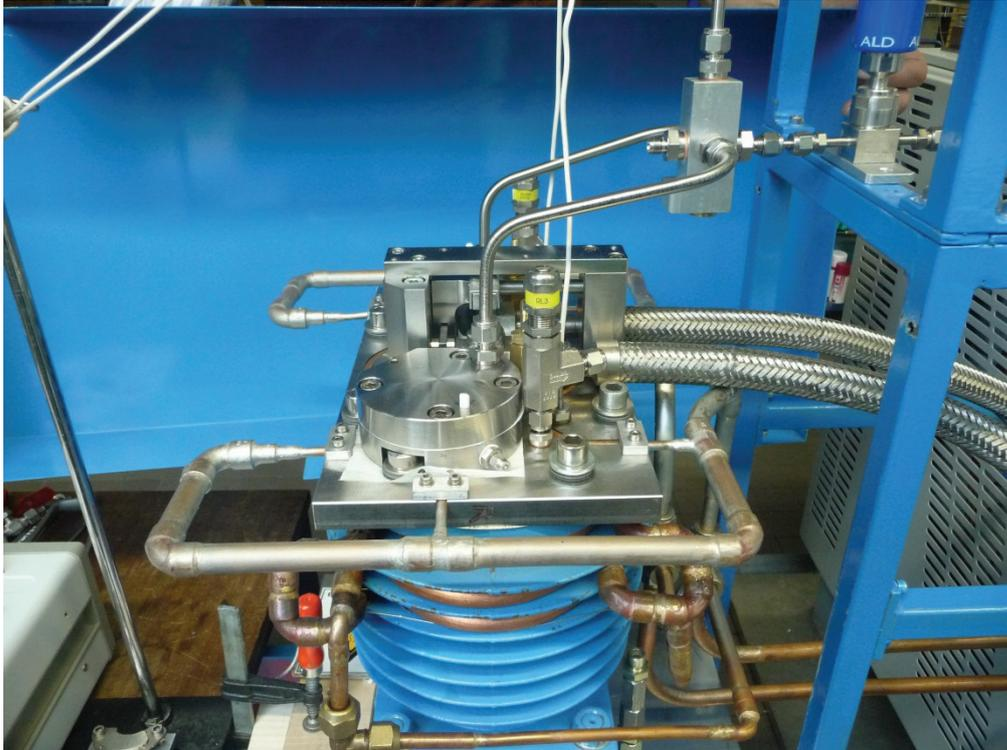
Abbildung 1: Zylinder (blau) und beheizter Zylinderkopf mit Zyklon, Einlassrohren und flexiblen Auslassschläuchen
