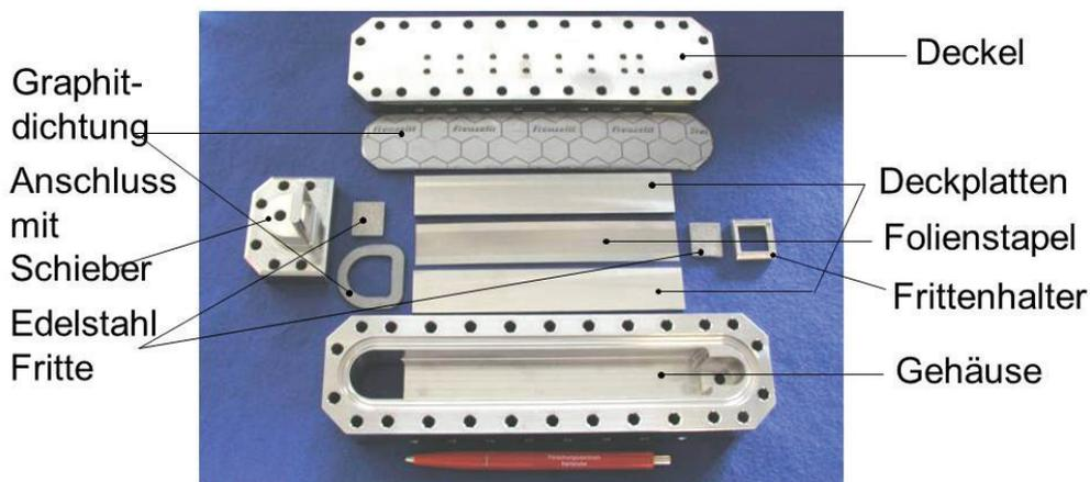
Abb. 2: Einzelkomponenten des eingesetzten elektrisch beheizten Laborreaktors für die Dehydrierung; über austauschbare mikrostrukturierte Folien kann ein einfaches Katalysatorscreening erfolgen.
