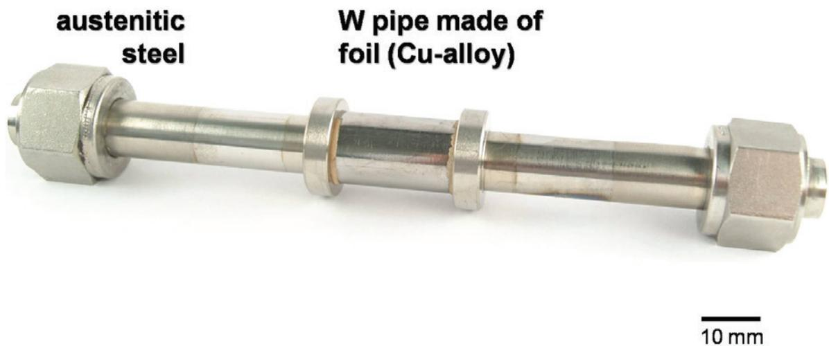
Abbildung 4: Aufbau eines Prüflings für einen Berstversuch. Das aus Wolframfolie gewickelte Laminatrohr befindet sich in der Mitte und ist zu beiden Seiten in ein Rohr aus Edelstahl (austenitischer Stahl) gefasst. Das Bild zeigt den Prüfling **nach** dem Versuch. Bei 1000 bar bei RT ist das Laminatrohr noch vollkommen intakt.
