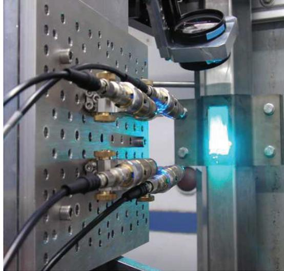
Abb. 5 Laser Doppler Profilsensor der TU Dresden
