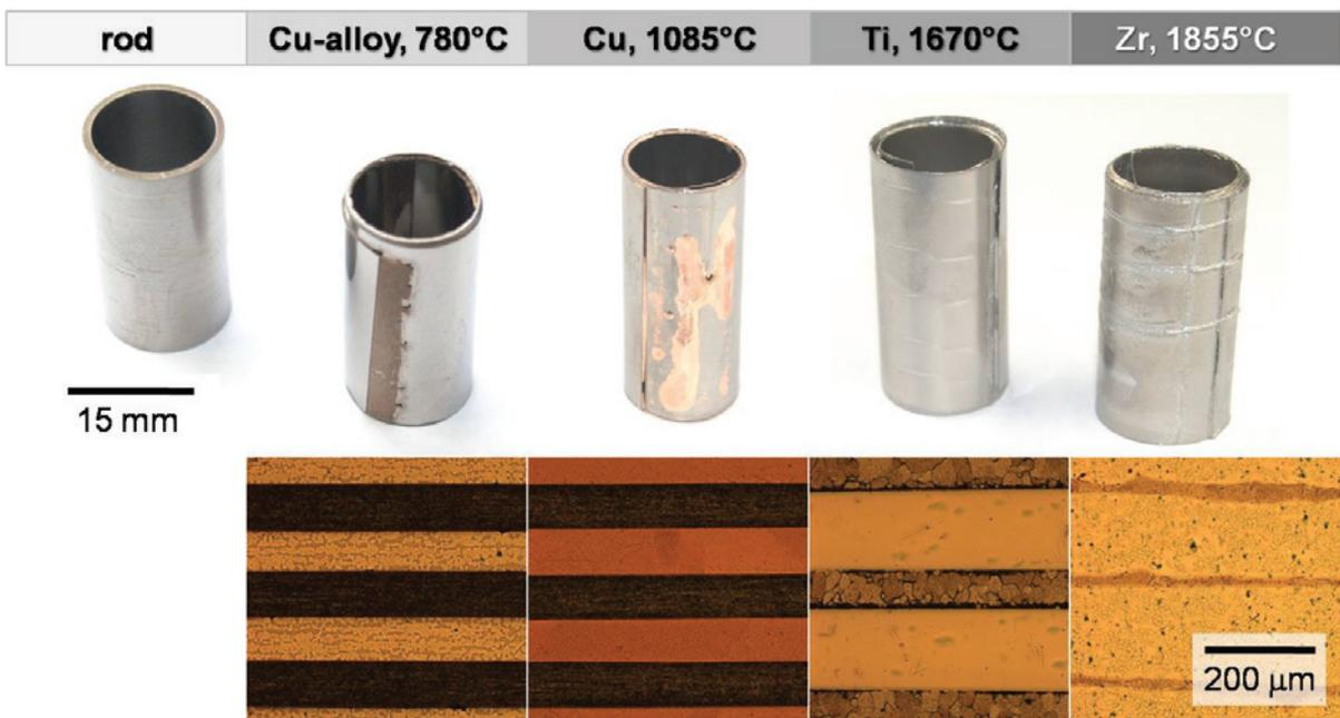
Abbildung 2: Abhängig von der Wahl der Zwischenschicht sowie der Verbindungstechnik ergibt sich eine spezifische Mikrostruktur des Laminats. Dabei ist der Zustand der Wolframfolie als auch die Art der Grenzfläche zwischen Wolfram und Zwischenschicht für die mechanischen Eigenschaften des Laminatrohrs entscheidend.
