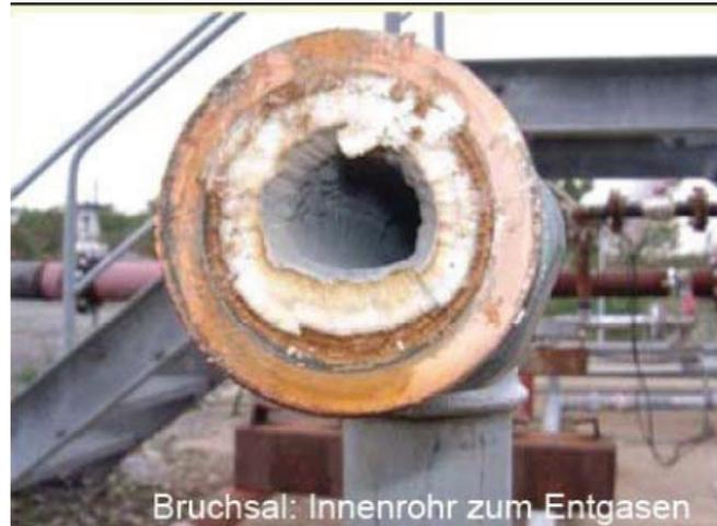
Abb. 2 Auswirkungen von Mineralausfällungen bei der Nutzung der Tiefengeothermie in Bruchsal [3]
